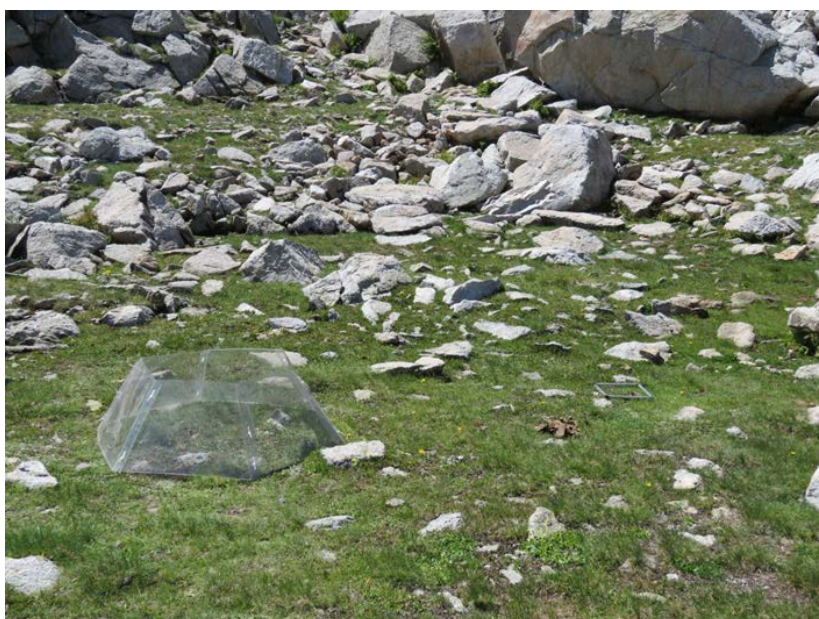
Figura 1. Una Open Top Chamber instalada en el nevero de Ratera.
