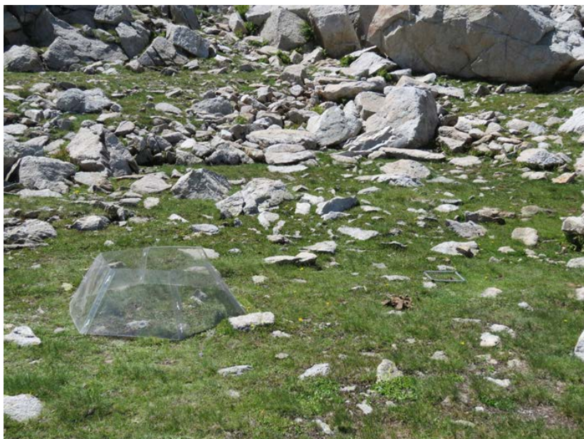
Figura 1. Una Open Top Chamber instal·lada a la congestera de Ratera.
